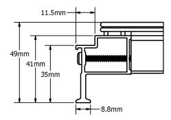
Figure 4: Long Edge Frame Detail
