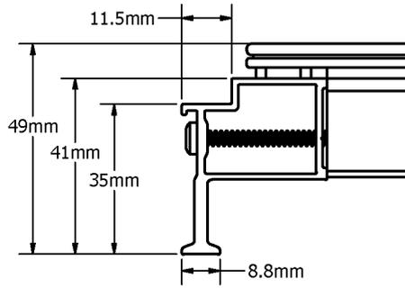
Figure 4: Long Edge Frame Detail
