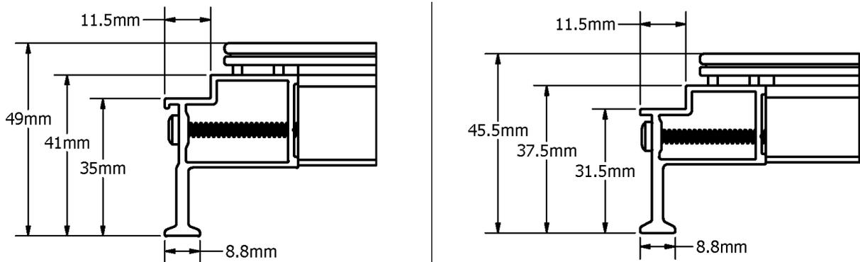
Figure 3: Long Edge Frame Detail
